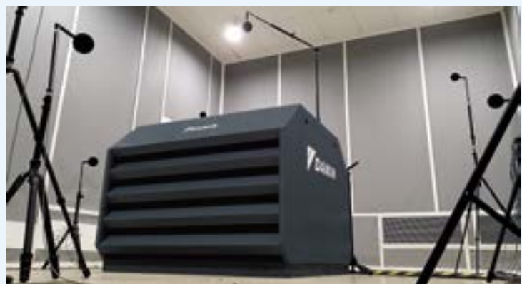
Pomiar poziomu mocy akustycznej w komorze akustycznej
