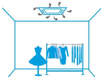
Rozkład powietrza z zabrudzonym filtrem
